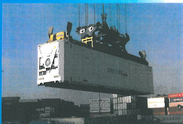
Die Position des Kühlaggregats macht den Unterschied: 32 oder 33 Euro-Paletten passen in den 45-Fuß Container.
