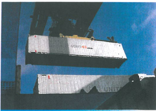
Die 45-Fuß Container können die gleiche Infrastruktur nutzen wie die 40-Fuß ISO-Container.
